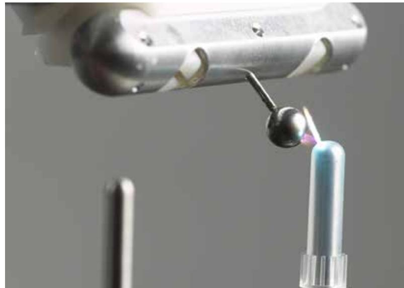
**LeakTEC ist ein leistungsfähiges Werkzeug für die zerstörungsfreie Dichtigkeitsprüfung an nicht leitenden einschichtigen Materialien. Das System LeakTEC misst ein Loch zwischen einer Hochspannungselektrode (DC) und einer Gegenelektrode, die entweder geerdet oder mit umgekehrter Polarität angeschlossen sein kann. Das System LeakTEC stellt die vollständige Prozesssteuerung und Nachverfolgbarkeit sicher.**
